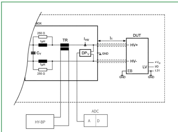
DP<sub>V</sub> : 用于高压电压测量的差分探头
